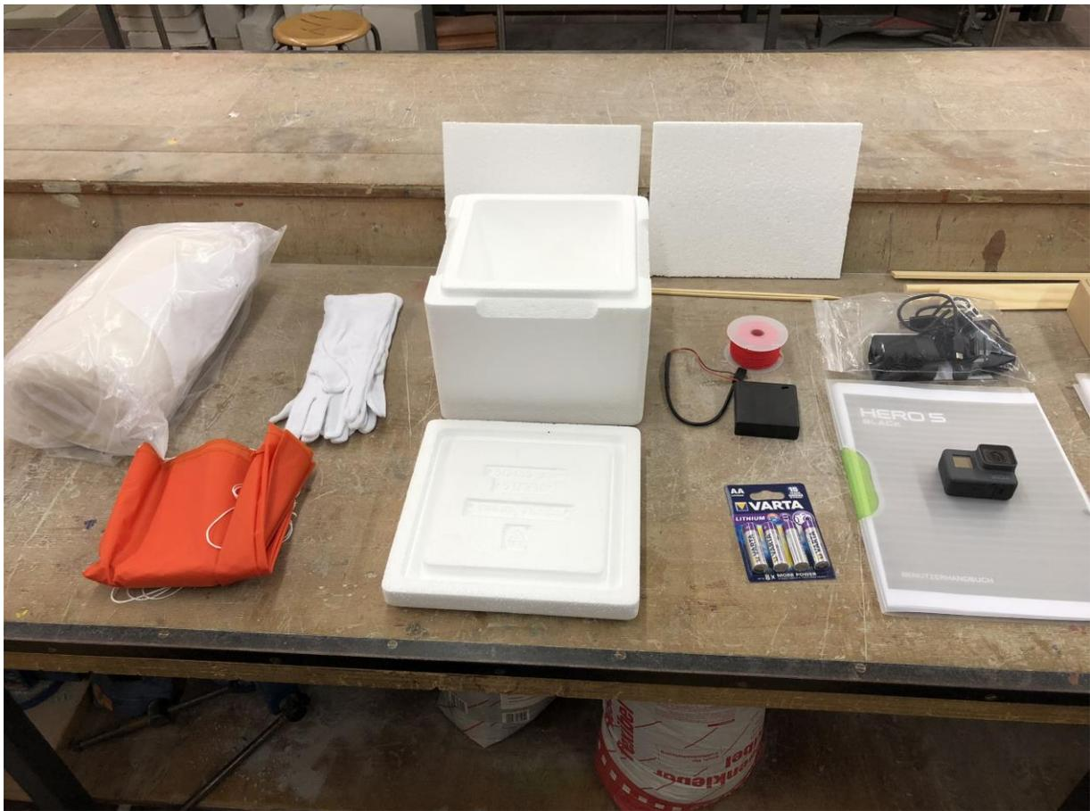
Links der Ballon, der Fallschirm und der Sondenkörper mit den 'Flügeln' damit die Sonde nicht zu sehr rotiert.
