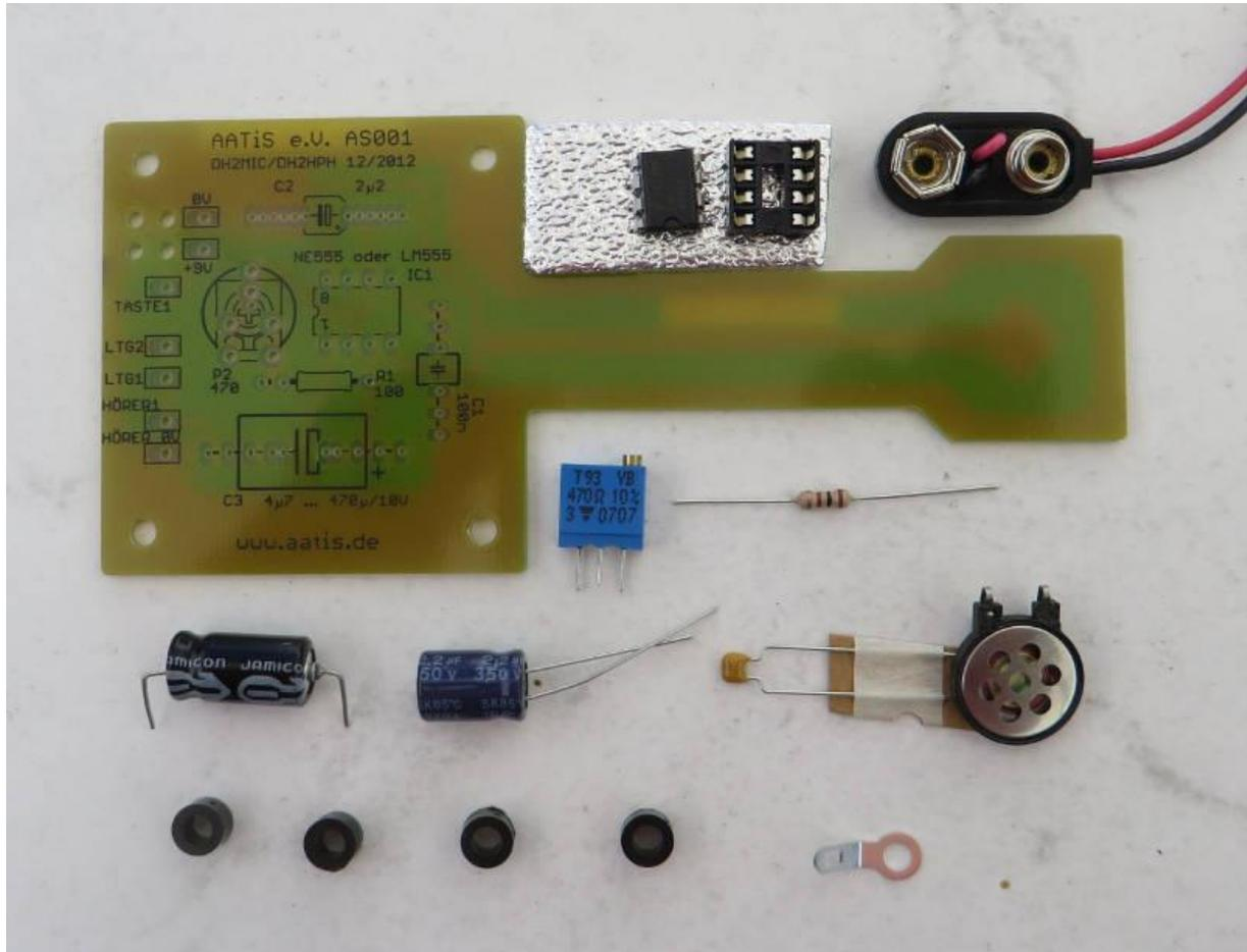
Zunächst wurde die Platine bestückt. Hierbei war zu beachten, dass die bereits eingesetzten Teile beim Umdrehen der Platine zum Löten nicht wieder heraus fielen.
